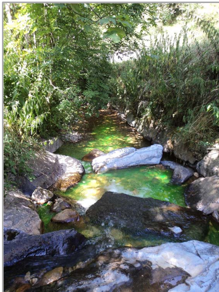
Markierversuch 2015 im Flüebach (Emmental) mit Grundwasseranbindung Essai de traçage 2015 dans le Flüebach (Emmental) en relation avec les eaux souterraines (C. Carlier, Centre d'hydrogéologie et de géothermie, université de Neuchâtel)
