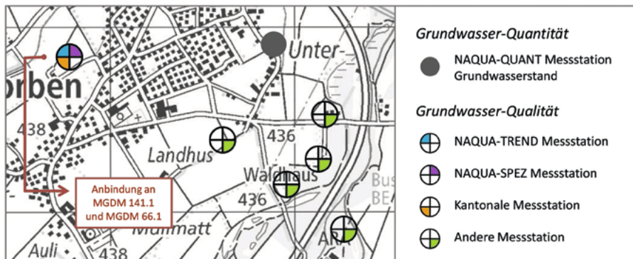
Fig. 8 Messstationen zur Erhebung der Grundwasser-Quantität (Visualisierung «Werteehebung») und Grundwasser-Qualität (Visualisierung «Messnetz») gemäss Darstellungsmodell Bund. Eines der dargestellten Objekte ist – analog Fig. 5 – als Messstation mehreren Messnetzen zugeordnet (MGDM 133.2, 133.5, 134.3). Gleichzeitig kann es über die räumliche Position an das MGDM 141.1 (Grundwasserbrunnen) sowie das MGDM 66.1 (Fassungsbrunnen) angebunden sein (siehe auch Fig. 9 ).
